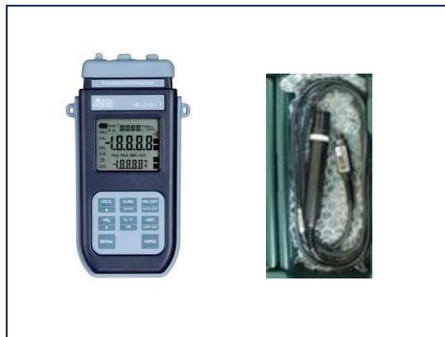
Figura 2. Patrón viajero usado en la comparación HRc-24 para participantes con cámara climática.
