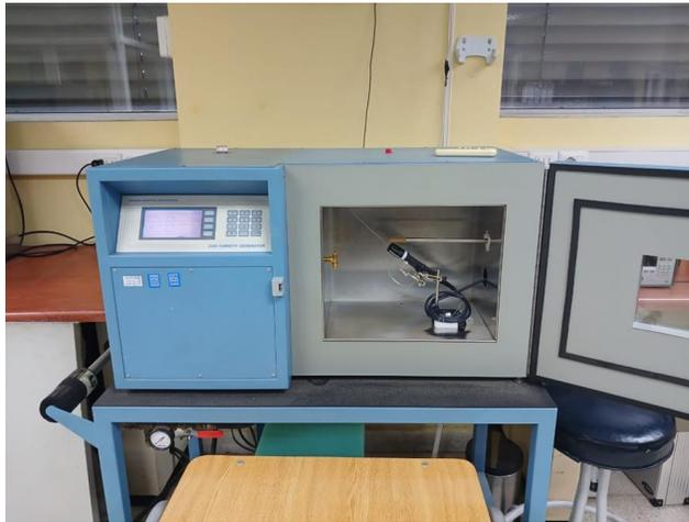
Figura 3. Montaje para la calibración del patrón viajero.
